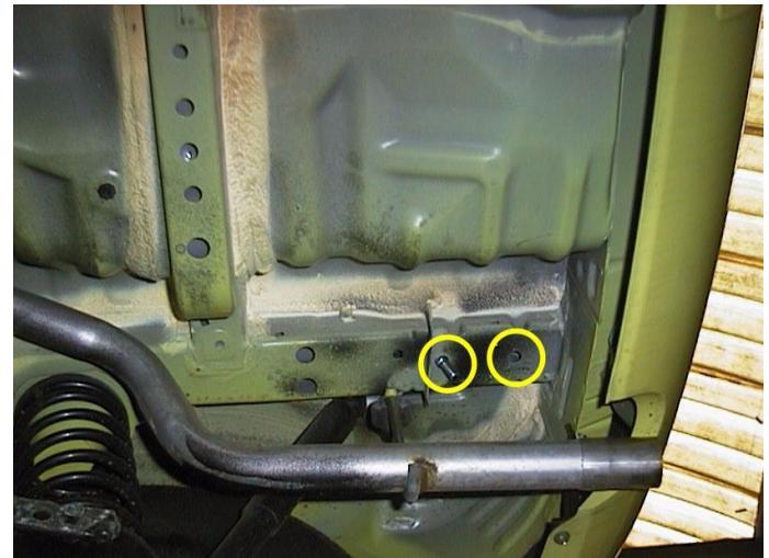
Foto2: (Rechts) deze gaten vergroten tot ø17 mm
