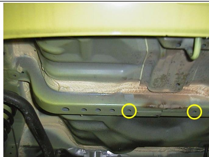
Foto3: deze gaten doorboren tot in de koferraumte
